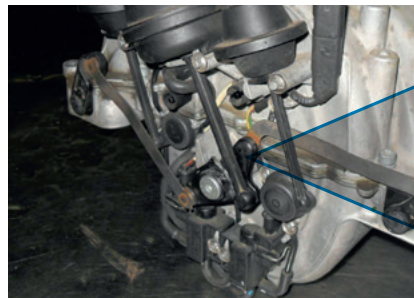
Manifestación de la avería: rotura en el varillaje de mando
