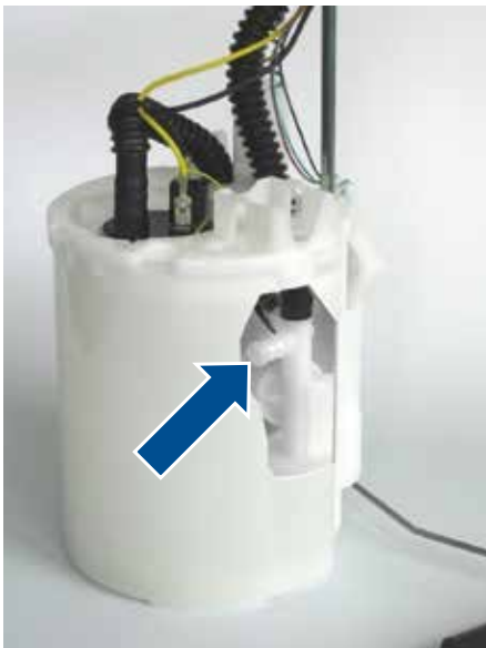
Fig. 1: Vista del módulo de alimentación de combustible (vista de sección) con conector ciego
