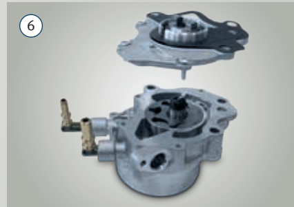
Pompa tandem: pompa di alimentazione olio/pompa per vuoto combinata
