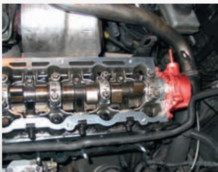
Le pompe per vuoto monopaletta, azionate da un albero a camme, rappresentano lo stato odierno della tecnica.
