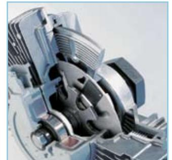
Eine auf der Vorderseite der Lüfterkupplung angebrachte Steuerung reagiert auf die Temperatur des Luftstroms: Sie öffnet und schließt ein Ventil im Inneren der Kupplung.
