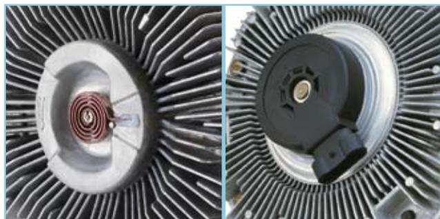
Die Steuerung der Viscokupplung erfolgt je nach Hersteller bzw. Bautype durch ein Bimetall (Bild oben links) oder elektronisch durch die von BorgWarner entwickelte VISTRONIC® (Bild oben rechts). Diese Weiterentwicklung der Viscokupplung wird vom Motormanagement elektronisch angesteuert und weist eine deutlich kürzere Reaktionszeit auf.
