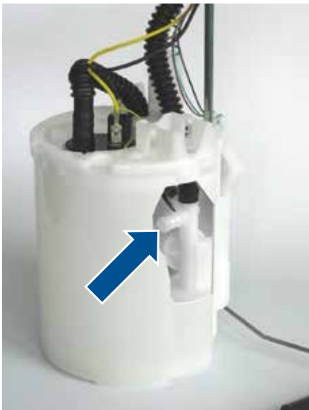
Abb. 1: Blick in das Kraftstofffördermodul (aufgeschnitten) mit Blindanschluss
