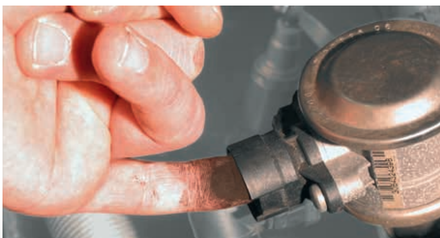
Krótki przegląd zaworu powietrza wtórnego w BMW 520i (zaznaczony)
