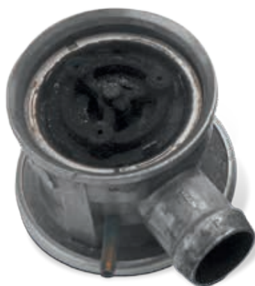
Uszkodzenie spowodowane przez skroplone spaliny
