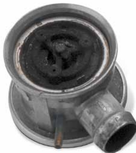
Skada genom avgaskondensat
