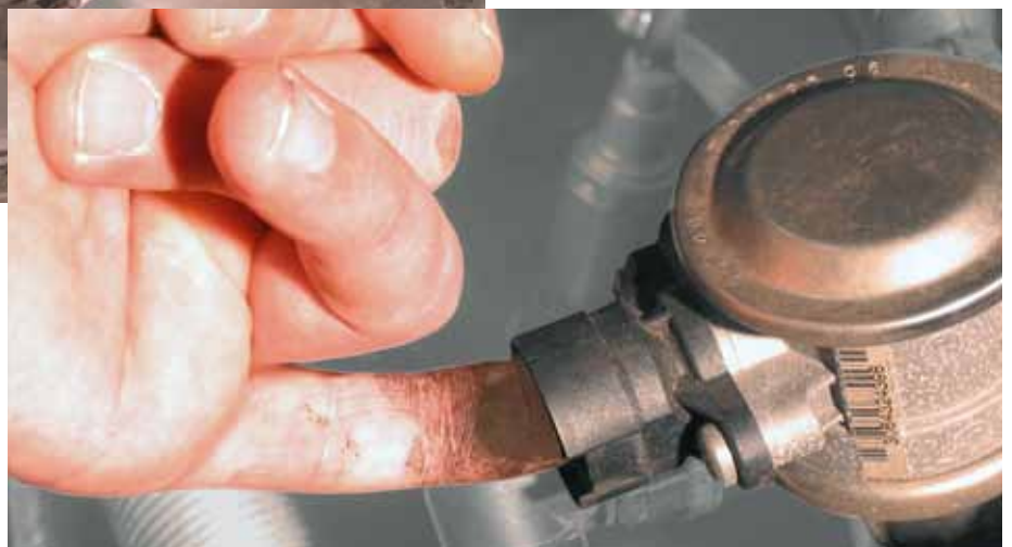
Snabbkontroll på sekundärluftventil i BMW 520i (markerad)
