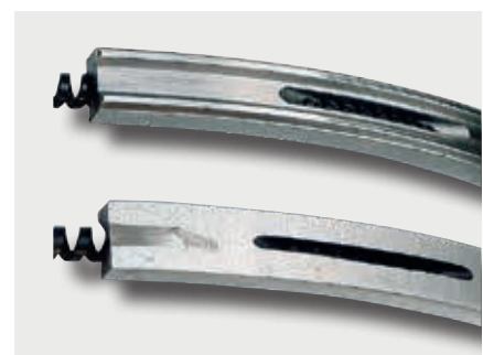
Abb. 3: neuer (oben) und ein durch Mischreibung verschliffener Ölabbreifring (unten).
