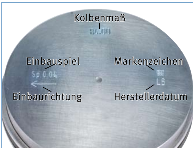
Abb. 1 Markierungen am Kolbenboden Bild © MS Motor Service International GmbH
