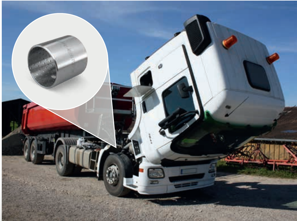
KS PERMAGLIDE® kaymalı yatak burcu Yapı türü PAP ... P20 ile yataklama
