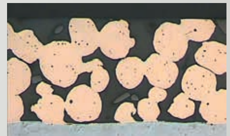
4. ábra: Csapágy állapota a bejáratási folyamat végén. A bronzréteg lett a futófelület.
