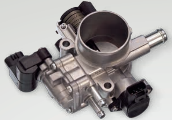
Şek. 8: Gaz kelebeği manşonu kullanımı
