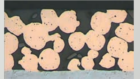
Şek. 4: Alıştırma işleminin sonunda durum. Bronz tabaka, taşımaya başlar.
