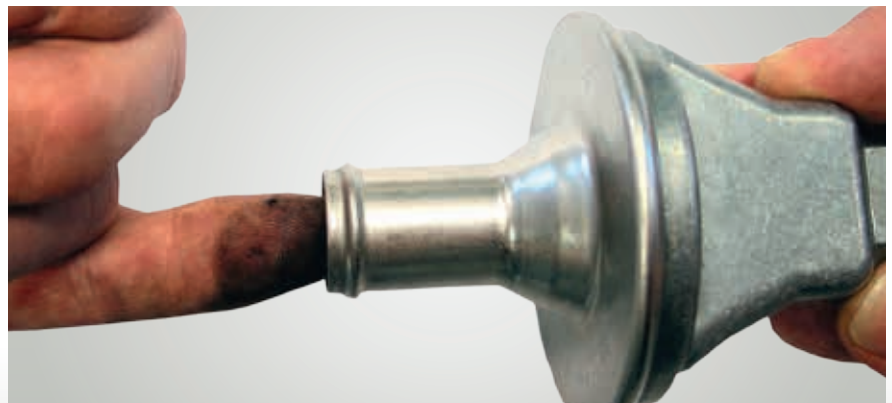
Fig. 1: Simple control de la válvula de retroceso
