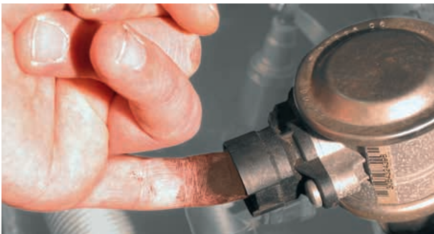
Control rápido en la válvula de aire secundario en el BMW 520i (en primer plano)
