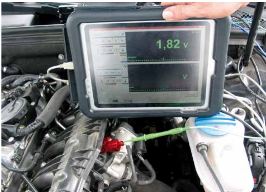
Mätning av utgångsspänningen på insugningsrörets tryckgivare (markerad) i Audi A4 TFSI
