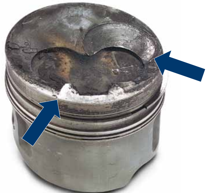
Fig. 4: impacts de choc dus à une surchauffe du moteur
