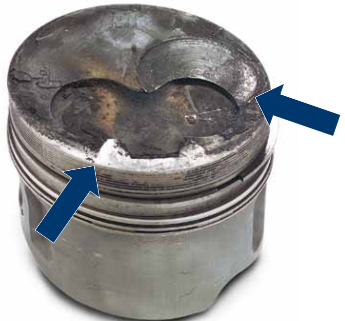
Fig. 4 Sinais de colisão devido ao sobreaquecimento no motor
