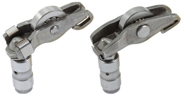
Bild 1: 423 0079 10 – Links die alte Ausführung, rechts die neue Ausführung
