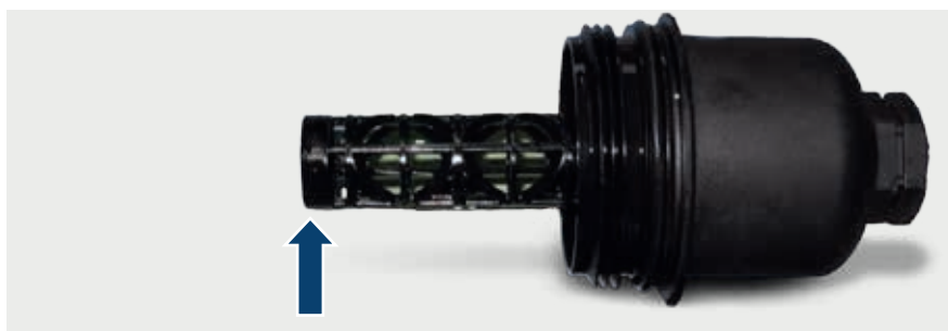
Fig. 2: Punto di rottura sul tubo di plastica, la chiusura della valvola di drenaggio manca
