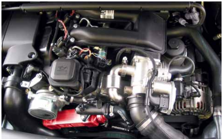
Afb. 2: EGR-koeler in een BMW 318d (rood geaccentueerd)
