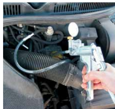
Op pneumatische EGR-kleppen of zoals hier een EPW: met een handonderdrukpomp kan het functioneren gemakkelijk worden gecontroleerd.
