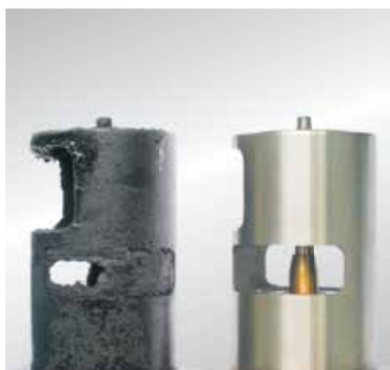
Omdat EGR-kleppen niet van zelf onder het roet kunnen komen, moet naar de oorzaak van het roet worden gezocht.
