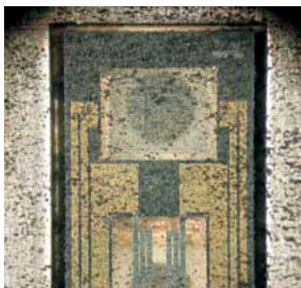
Zout en vuil kunnen de sensor van een luchtmassasensors beschadigen – in ieder geval vervangen ze de metingen, hetgeen weer invloed kan hebben op de EGR.
