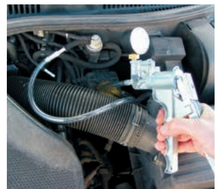
Ob pneumatische AGR-Ventile oder wie hier ein EPW: Mit einer Handunterdruckpumpe lässt sich die Funktion leicht prüfen.
