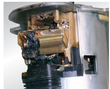
Imagem de danos: vestígios de derretimento no motor elétrico ou nos contatos elétricos
