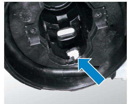
Imagem de danos: vestígios de derretimento na carcaça (carcaça vista de cima)
