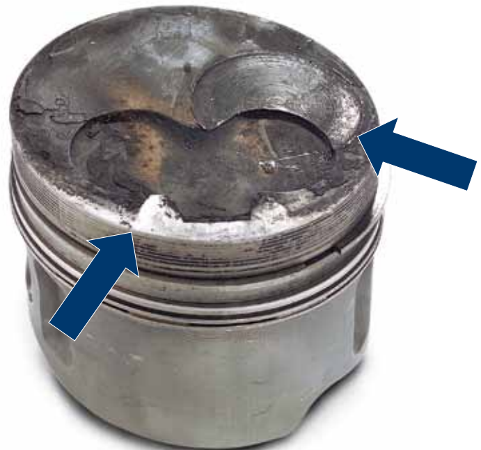
Fig. 4: huellas de golpes por sobrecalentamiento del motor
