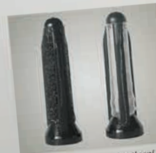
Rys. 22: Filtr siatkowy pompy łopatkowej E1; F z lewej strony zapchany - z prawej strony nowy
