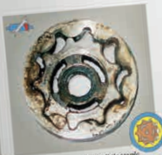
Rys. 19: Zablokowany zespół tłoczenia (pierścień zębaty trochoidalny) pompy z pierścieniem zębatym E3T
