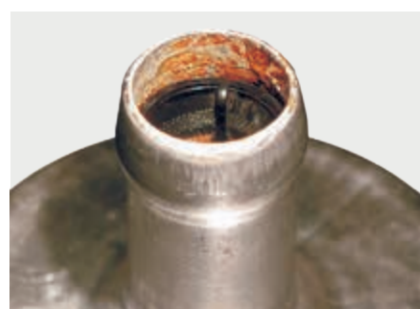
Zardzewiały wlot pompy (uszkodzenie przez wodę)
