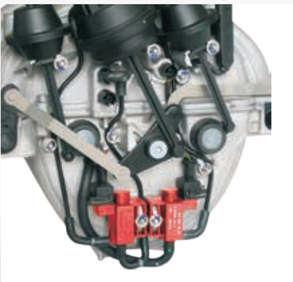
Elektromechanisches Ventil am Saugrohr der Mercedes-Benz C-Klasse (hervorgehoben).
