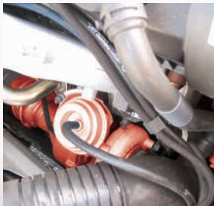
Elektropneumatischer Druckwandler und Turbolader im Audi A4 TDI (hervorgehoben).
