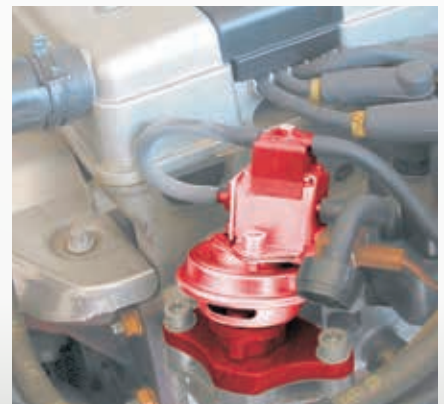
Elektrischer Druckwandler am AGR-Ventil im Opel Astra (hervorgehoben).
