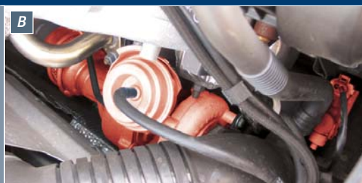
B Elektropneumatische druk-converter (EPW) en turbocompressor in een Audi A4 TDI (rood).
