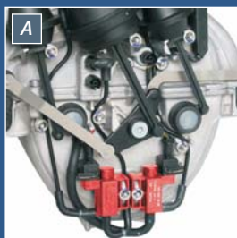
A Elektro-wisselklep (EUV) (rood) aan het inlaatspruitstuk van de Mercedes C-klasse.
