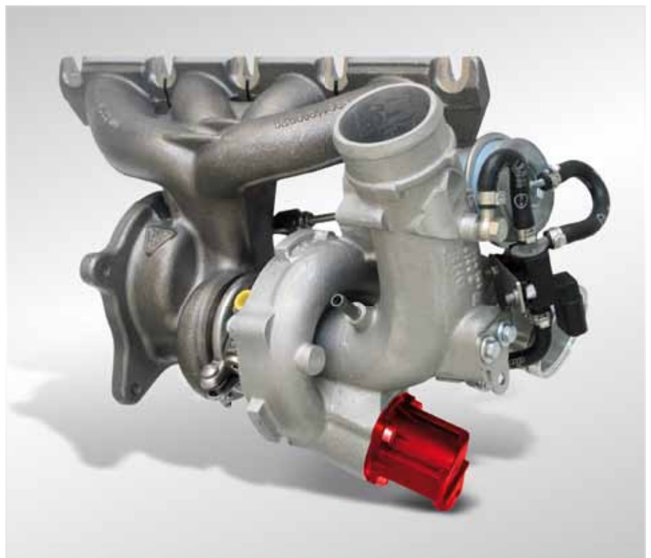
Pop-off-klep (geaccentueerd) op de turbolader van een Audi A3 2.0 TFSI
