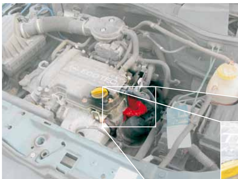
Elektrický ventil AGR u Opel Corsa (zvýrazněno)
