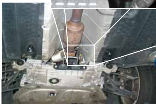
Decelerační ventil recirkulace vzduchu v VW EOS TFSI (červeně zvýrazněno)
