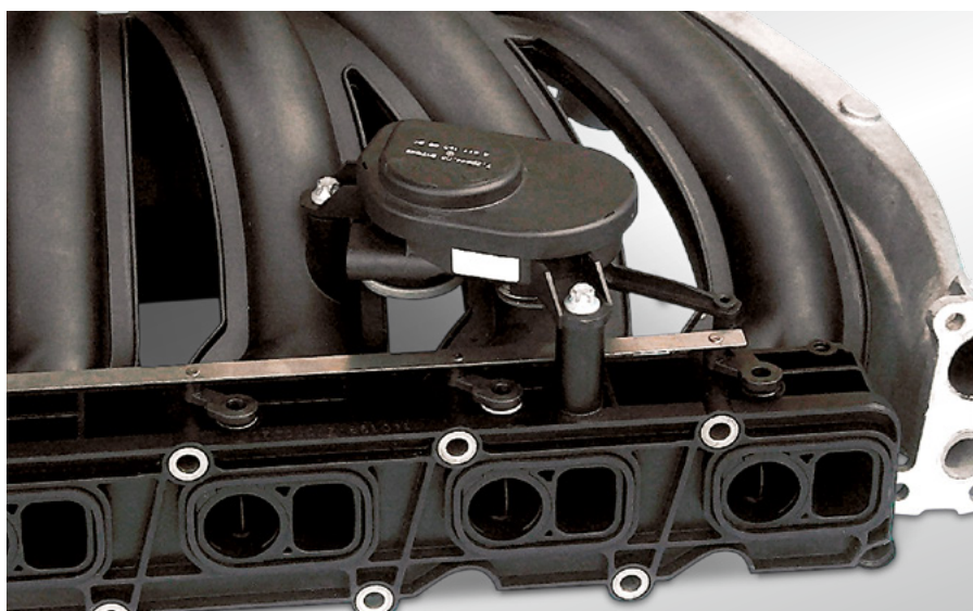
Rys. 41 Kolektor dolotowy z klapę wirową i elektrycznym modułem napędowym EAM-i ze zintegrowaną „inteligencją”
