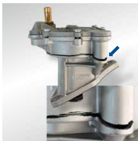
Fig. 1: Quebra na caixa da bomba
