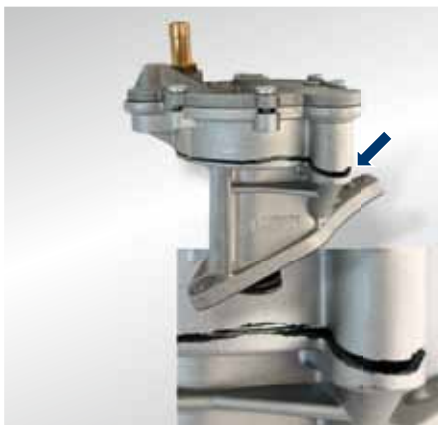
Fig. 1: Rotura en la caja de bomba
