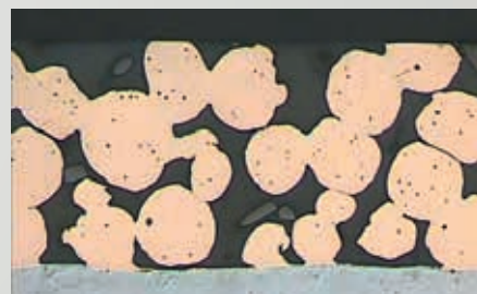
Fig. 4: Condizioni alla fine del processo di rodaggio. Ha inizio l'applicazione dello strato di bronzo.
