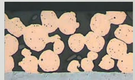
Fig. 4 : état de la surface de glissement à la fin du rodage La couche de bronze commence à porter.
