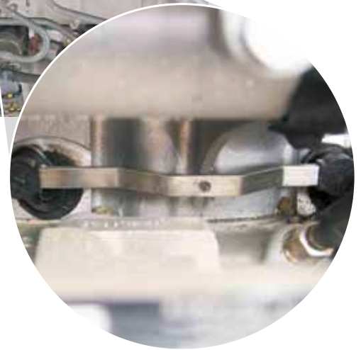
Tringlerie de commande du collecteur d'admission d'Opel Vectra (marqué en rouge et en vue détaillée).
