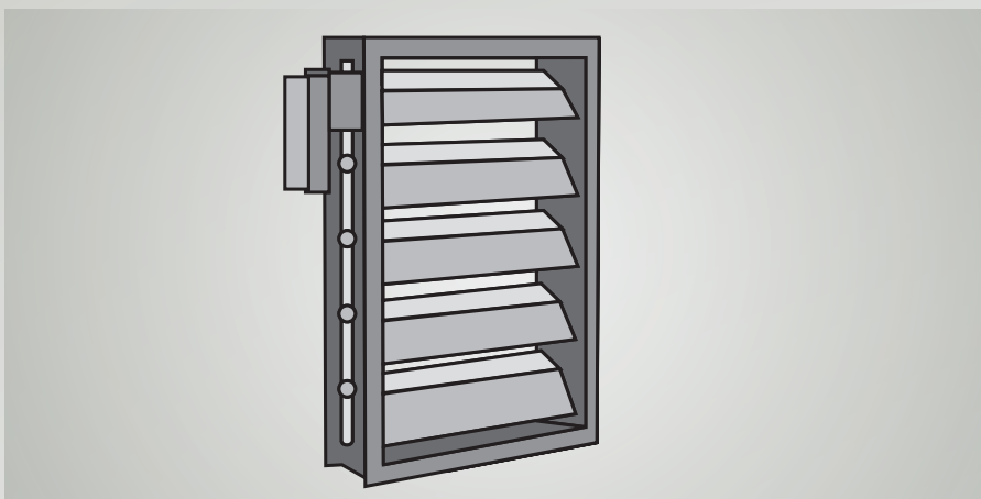
Láminas de la compuerta cortafuegos dispuestas en fila
