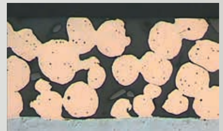
Fig. 4: Estado al final del proceso de rodaje. La capa de bronce comienza a absorber la carga.
