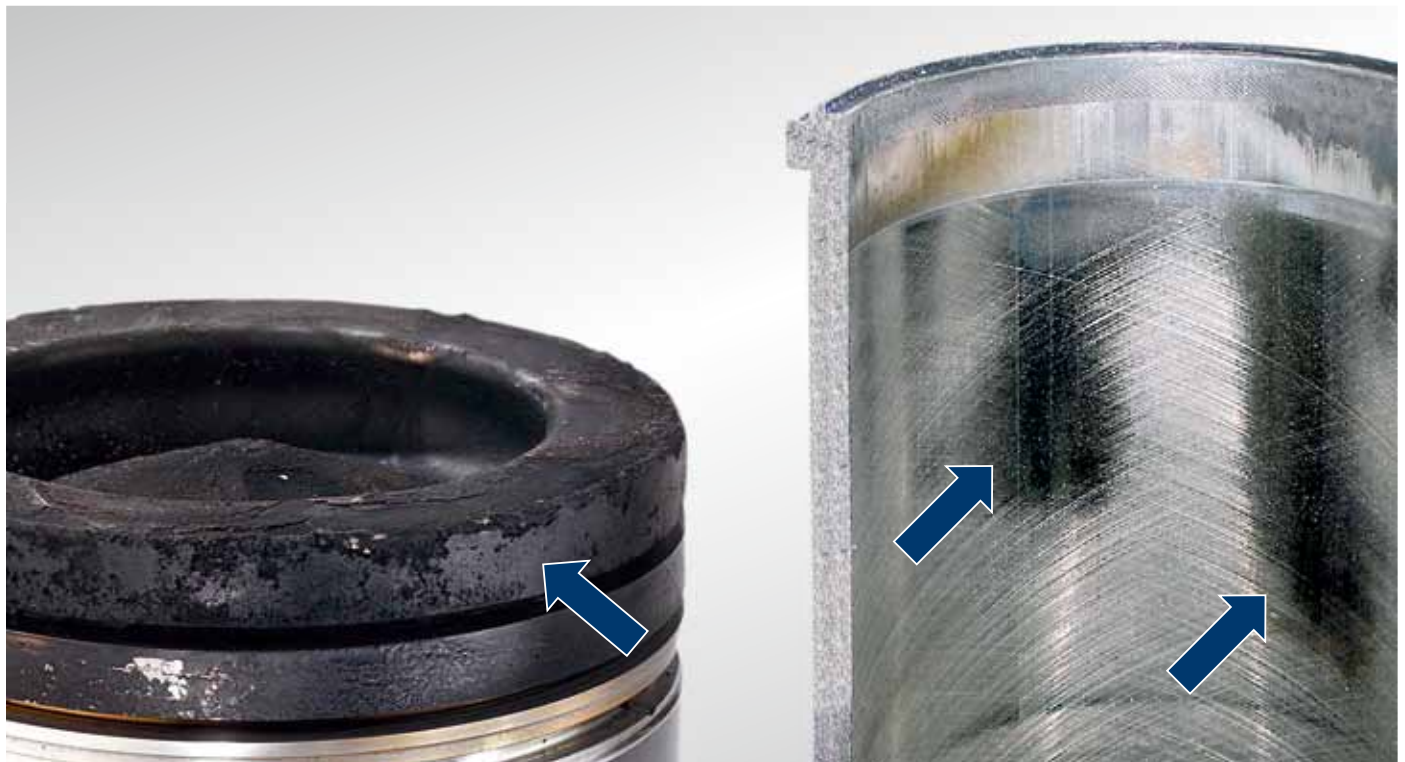
Fig. 4 Camada de óleo carbonizado no ressalto de ignição e desgaste abrasivo na superfície de deslizamento do cilindro
