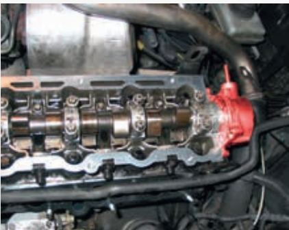
El estado actual de la técnica lo constituyen las bombas de vacío monopaleta, que se accionan mediante el árbol de levas.
