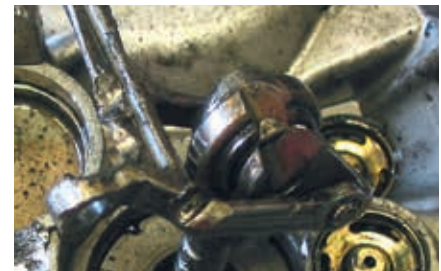
Manifestación de la avería: palanca oscilante completamente destruida
