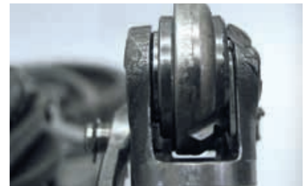
Manifestación de la avería: rodillo de deslizamiento desgastado de un lado
