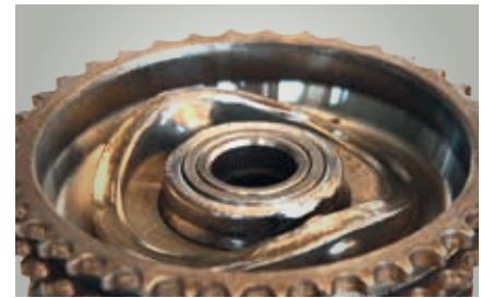
Disco de leva desgastado
