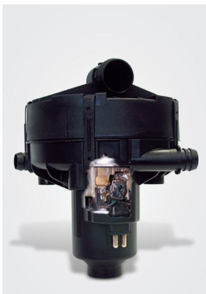
Widok wnętrza pompy powietrza wtórnego (przekrój) ze śladami nadtopienia
