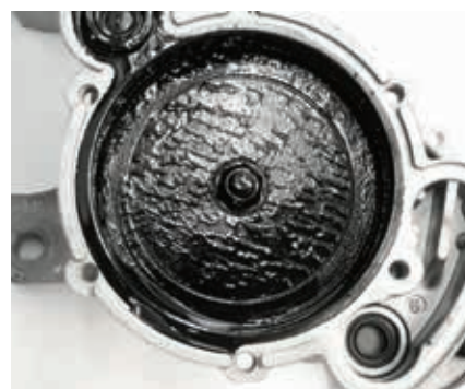
Fig. 3: Crusta de ulei din pompa de vid de la vehiculul comercial VW Transporter duce la apariția huruiturilor
