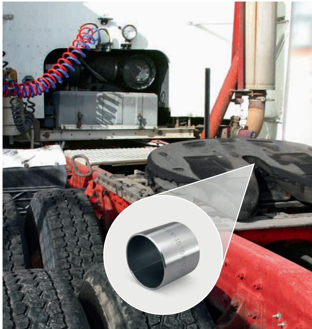
Lagerung in Sattelkupplung mit KS PERMAGLIDE® P10 Gleitlagerbuchsen
