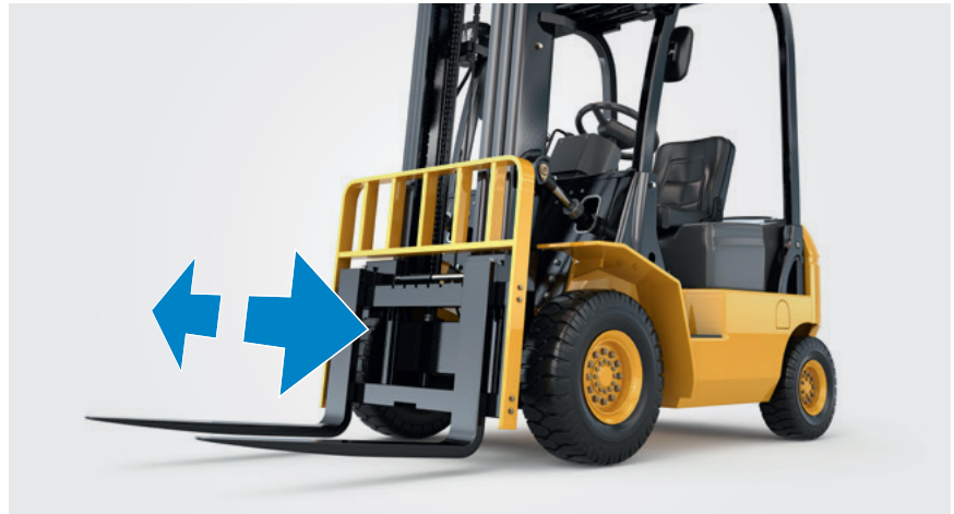
Guiado de la regulación lateral de la horquilla
