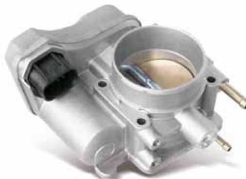
Ștuț de clapete de accelerație „drive-by wire”
