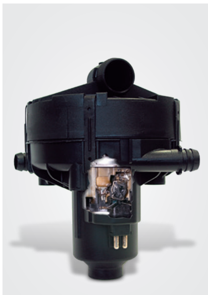
查看二次空气泵内部 (剖面) 带有熔痕
