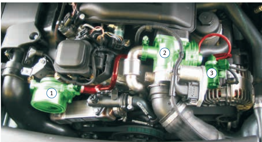
示例 BMW 118d (E87), (标绿: 真空系统中的部件, 标红: 真空软管)
