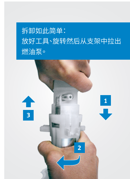
该工具张开将燃油泵固定在燃油供给模块的支架。它尤其适用于带弯型压力管接头的燃油泵。
