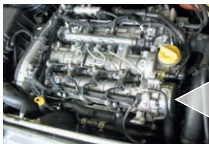
举例：欧宝威达（Opel Vectra）通过凸缘内的孔来实现润滑油供给。
