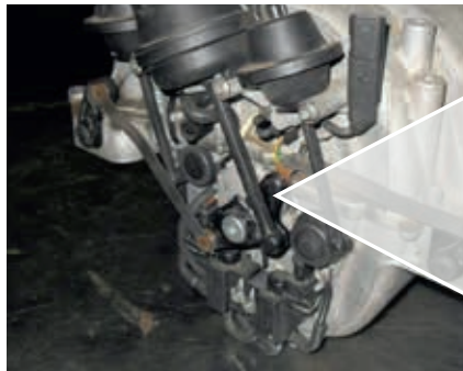
损坏图: 切换杆断裂
